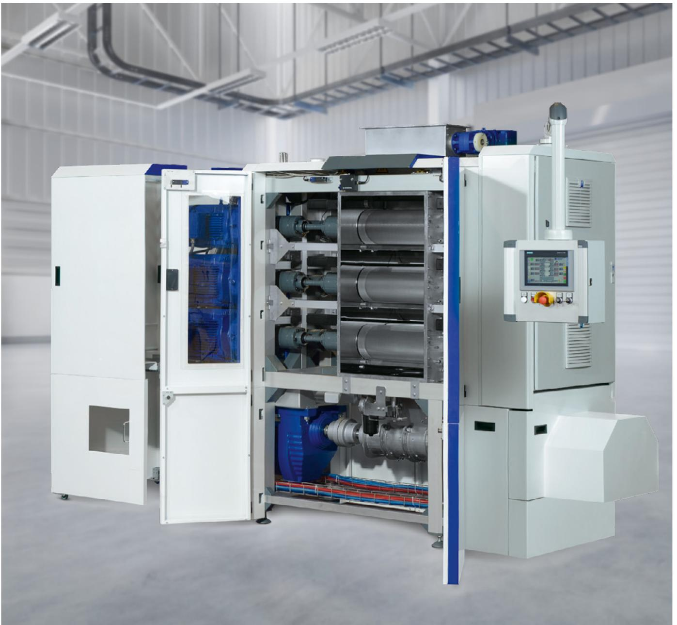
Das Mahlwerk NEOGRIND wurde speziell für anspruchsvolle Anforderungen an die Kontrolle über die Mahlpartikelverteilung (PSD) entwickelt und zeigt seine volle Leistungsfähigkeit u. a. bei der Vermahlung für den Single Cup – Bereich (Kapseln, Pads, etc.). Durch die Wasserkühlung sämtlicher Walzen und des Kompaktors ist auch bei intensiver Vermahlung ein niedriges Temperaturniveau im Mahlprozess gewährleistet.
