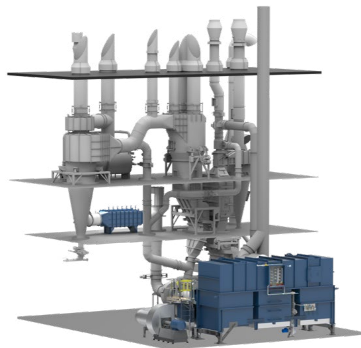
↑ RFB-E mit elektrischem Heizregister und RTO-Abgasbehandlung
