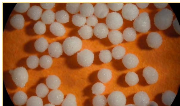
**Schichtartiger Aufbau runder Granulate**
