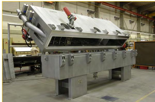
**Kontinuierlich arbeitende Wirbelschichtanlage mit Sektioneneinteilung**
