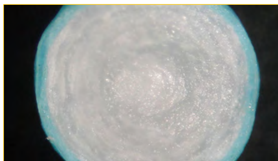
Pellet mit einer funktionellen Coatingschicht
